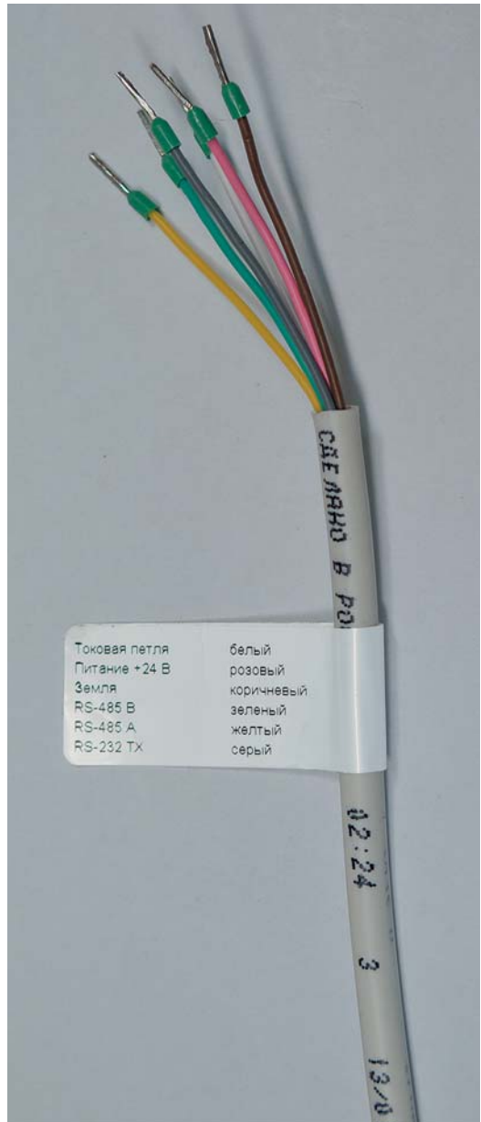
Рис.7. Цветовая маркировка кабеля
