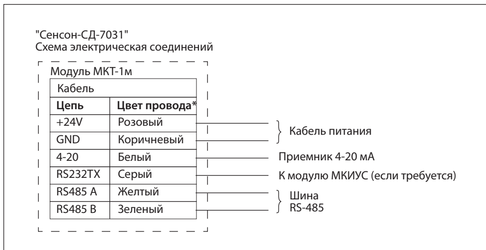
Рис.6. Схема подключения газоанализатора "Сенсон-СД-7031"
