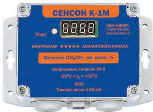
Контроллер аналоговых сигналов "Сенсон К-1М" – стационарный прибор, предназначенный для приема данных от внешних газоанализаторов (например, "Сенсон-СД") по каналу "Токовая петля 4-20 мА". Он обеспечивает индикацию численного значения концентрации газа, световую звуковую сигнализацию о превышении заданных пороговых концентраций, управление внешними устройствами. Значения контролируемых параметров можно задавать с помощью встроенной клавиатуры.
