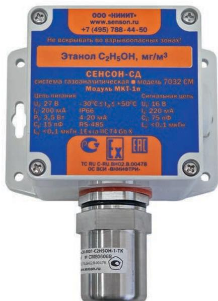
Газоаналитическая система "Сенсон-СД-7032-СМ" – это стационарный одноканальный прибор для непрерывного контроля концентрации газа в рабочей зоне. Он обеспечивает высокий уровень противоаварийной защиты в зонах, где возможно превышение концентрации горючих и токсичных веществ, а также превышение/снижение концентрации кислорода.
