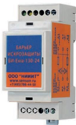
Барьеры искрозащиты БИ-ЕхIа-xxx-24 предназначены для обеспечения уровня защиты искробезопасной цепи ia при питании взрывобезопасного оборудования категории IIC и ниже. Барьер защищает канал электропитания 24 В по искробезопасной цепи, а также канал интерфейса "Токовая петля 4-20 мА".
