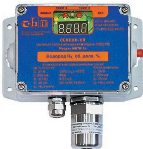
Газоаналитическая система "Сенсон-СВ-5022-СМ" – это стационарный одноканальный прибор для непрерывного контроля концентрации газа в рабочей зоне. Он предназначен для общепромышленных применений, внутри и вне помещений. Конструкция прибора исключает доступ к управляющей электронике в процессе эксплуатации, и в то же время обеспечивает простоту смены интеллектуального сенсорного модуля "Сенсон-СМ-9001".
