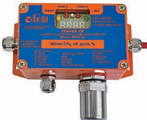
Газоаналитическая система "Сенсон-СВ-5023-СМ" – это стационарный одноканальный прибор для непрерывного контроля концентрации газа в рабочей зоне. Он предназначен для общепромышленных применений, когда требуется повышенная механическая прочность. Возможен как диффузионный пробоотбор, так и принудительная подача проб.
