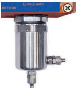
Возможно технологическое исполнение системы "Сенсон-СД-5023-01-СМ". В этом случае крышка сенсорного модуля снабжается двумя штуцерами для принудительной подачи и отвода анализируемой газовой смеси по трубке внутренним диаметром 4 мм и внешним 6 мм.
