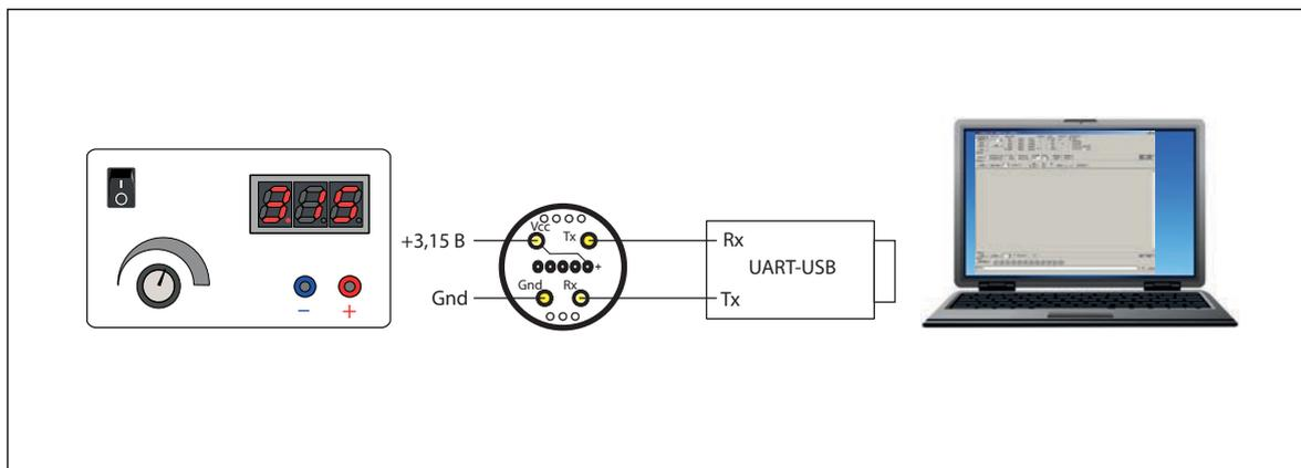
Рис.2. Схема подключения газоанализатора "Сенсон-СМ-9001"
