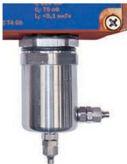
Возможно технологическое исполнение системы "Сенсон-СД-7033-01-СМ". В этом случае крышка сенсорного модуля снабжается двумя штуцерами для принудительной подачи и отвода анализируемой газовой смеси по трубке внутренним диаметром 4 мм и внешним 6 мм.
