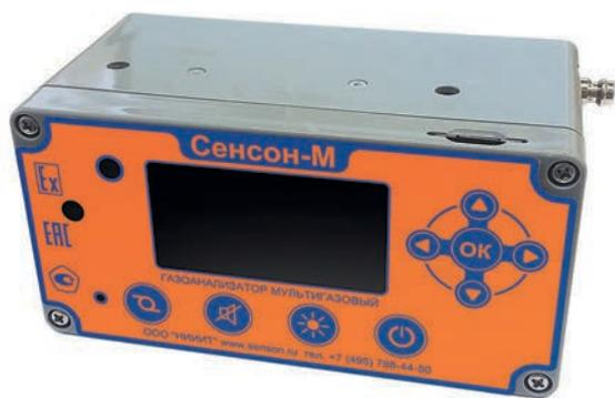
Переносной мультигазовый газоанализатор "Сенсон-М" предназначен для мониторинга атмосферного воздуха и технологических сред (от 1 до 6 каналов измерений). Измеренные значения отображаются на цифровом дисплее. При достижении порогового уровня концентрации включаются световой и звуковой сигналы. Прибор может запоминать результаты измерений в сменной карте энергонезависимой памяти с последующей передачей их на компьютер для хранения и обработки.
